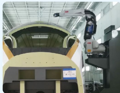
● 中车长春轨道客车股份有限公司高铁车辆机器人自动喷涂系统
