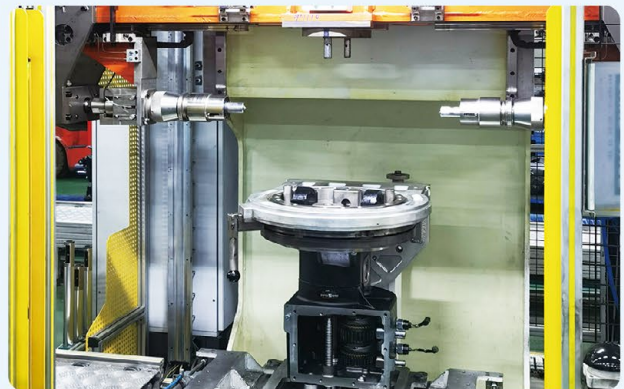
● 安徽合力机械 / 液力斜齿轮装配
