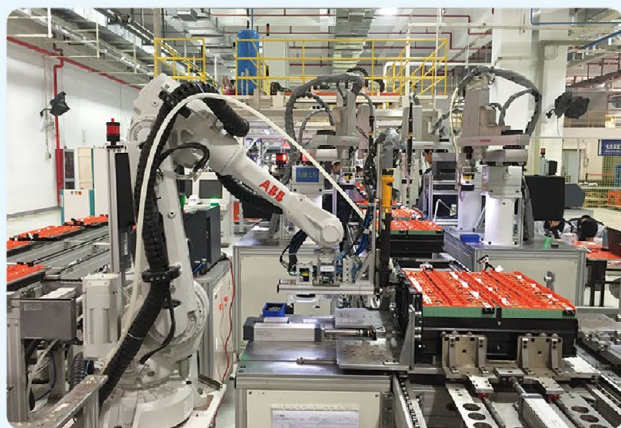
● 天津捷威动力电池模组智能装配线
